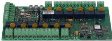
Les coupleurs 12 relais permettent de piloter un Centralisateur de Mise en Sécurité Incendie (CMSI) conventionnel.
