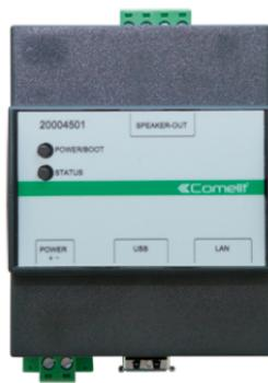
Module serveur et lecteur pour le système de diffusion sonore sur réseau LAN Comelit. Amplificateur stéréo 20+20 W 4 Ohms incorporé. Bornes pour la connexion directe des diffuseurs sur le module. Possibilité de configurer le module en mode serveur sur des installations comptant jusqu'à 16 zones audio, ou en mode lecteur. Configuration depuis une page WEB incorporée. Installation sur rail DIN. Alimentation : 24 Vcc. Absorption maxi 72 W. Dimensions : 4 modules DIN.
