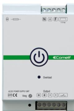
Alimentation à découpage pour fond de boîtier. Tension d'entrée 115/230 Vca, sortie stabilisée 24 Vcc. Courant de sortie 7A. Possibilité d'installer en parallèle plusieurs alimentations du même type. Comprend un contact sec qui permet d'activer une deuxième alimentation en cas de panne ou d'activer une signalisation sonore ou visuelle. Boîtier en aluminium et acier peint. Indice de protection : IP20.
