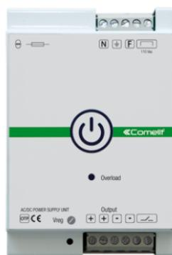
Alimentation à découpage pour fond de boîtier. Tension d'entrée 115/230 Vca, sortie stabilisée 24 Vcc. Courant de sortie 10A. Possibilité d'installer en parallèle plusieurs alimentations du même type. Comprend un contact sec qui permet d'activer une deuxième alimentation en cas de panne ou d'activer une signalisation sonore ou visuelle. Boîtier en aluminium et acier peint. Indice de protection : IP20.
