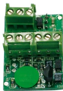
Module SimpleHome à sonde de température avec sortie 0-10V à encastrer, plage de mesure de 5 à 30°C. Utilisation exclusive avec module SimpleHome à 2 entrées analogiques (réf. 20046707) pour la régulation du système de climatisation. Précision de mesure égale à 0,1°C , dimensions 25x38x11 mm. Distance maximum entre la sonde de température et le module 2 entrées analogiques (réf. 20046707) : 15 m (avec câble blindé).
