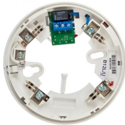
La base à relais pour les détecteurs normalisés est particulièrement discrète et le système de connexion au détecteur particulièrement fiable permet également le verrouillage de sûreté de ce dernier. La base présente un relais 12 Vcc pour l'interface avec les systèmes de sécurité. Peut également fonctionner avec réinitialisation. Dimensions : ø 102 mm x h 11 mm Poids : 46 g
