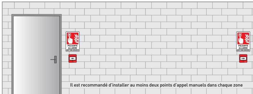
13.6.1.2 Il est recommandé d'installer autant de points d'appel manuel dans chaque zone, pas plus loin que 30m pour les zones à risque d'incendie bas ou moyen ou 15m pour les zones à risque d'incendie élevé. Certains d'entre eux doit être installé le long du trajet de sortie. Dans tous les cas au moins deux points d'appel manuels doivent être installés à côté de chaque issue de secours.
