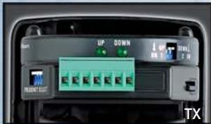
Au dessus du bornier de l'émetteur sont présents: le sélecteur de fréquence, le sélecteur de faisceaux, deux leds de signalisation (Up et Down).
