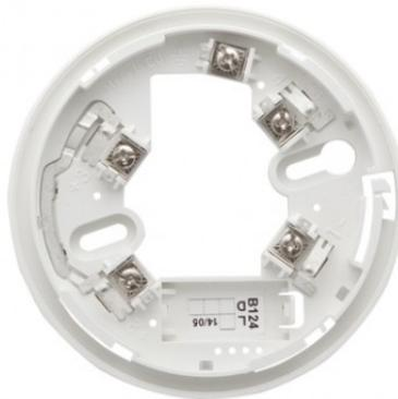
La base standard pour les détecteurs adressés est particulièrement discrète et le système de connexion au détecteur particulièrement fiable permet également le verrouillage de sûreté de ce dernier. Section maximale des câbles utilisables : 3,0 mm<sup>2</sup> Température de fonctionnement - 10 °C / +60 °C. Humidité relative de fonctionnement : (93 ± 3) % @ 40 °C. Dimensions : 103x14,7 mm. Poids : 15 g
