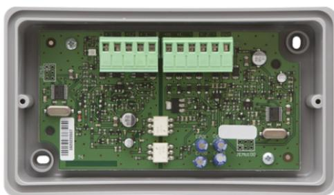
Le module adressé 41ISC000 permet de mettre en communication une zone normalisée alimentée séparément avec le système de détection d'incendie adressé. Il est alimenté par la boucle et est contrôlé par la centrale au moyen du protocole de communication. Bornes séparées 24 V pour l'alimentation de la ligne. Le module est protégé par un boîtier en plastique idéal pour la pose en saillie, avec couvercle transparent permettant l'inspection immédiate. Conforme EN 54-17 et EN 54-18.
