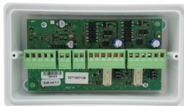
Le module adressé, avec isolateur incorporé, contrôle deux entrées équilibrées et commande deux sorties supervisionnées ou à relais, en fonction de la position des 2 cavaliers à l'intérieur du module. Le module est alimenté par la boucle et est contrôlé par la centrale à travers le protocole de communication. Le module est livré dans un boîtier en plastique permettant la pose en saillie et comprenant un couvercle transparent pour l'inspection visuelle immédiate.
