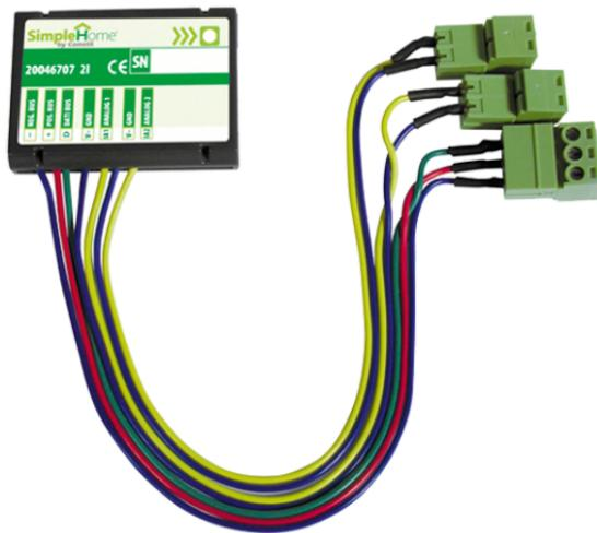
Module SimpleHome avec 2 entrées analogiques de série 0-10V, montage encastré dans boîtiers standards, associé à la sonde de température, il peut commander une sortie d'un module bus pour le contrôle d'une électrovanne locale. Dimensions 41x29x9 mm.
