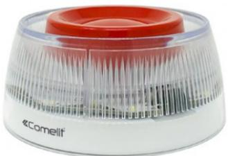
La sirène avec feu clignotant adressée 41SCI000, avec isolateur incorporé, est alimentée par la boucle et est contrôlée par la centrale au moyen du protocole de communication. Pour son montage, elle nécessite la base standard pour détecteurs adressés 41RBX020. Sirène conçue pour les installations extérieures grâce à la base indice IP65 Art. 41BSE000. La sirène est également équipée d'un isolateur incorporé. Certification EN54-3, EN 54-17, EN 54-23.
