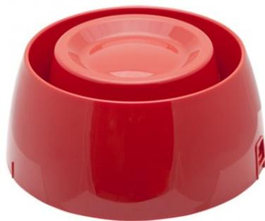
La sirène adressée 41SAI000, avec isolateur incorporé, est alimentée par la boucle et est contrôlée par la centrale au moyen du protocole de communication. Pour son montage, elle nécessite la base standard pour détecteurs adressés 41RBX020. Sirène conçue pour les installations extérieures grâce à la base indice IP65 Art. 41BSE000. La sirène est également équipée d'un isolateur incorporé. Certification EN54-3 et EN 54-17.
