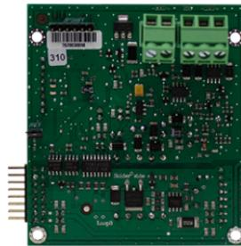
Carte d'extension 1 boucle pour centrale adressée Comelit série LogiFire art. 41CPE118 et box d'extension 41CPE104 (rétrocompatible avec la centrale ATENA 41CPE024). Avec bornier amovible et nombre maximum de dispositifs acceptés sur chaque carte : 250. Courant maximum 700 mA. Section des câbles utilisables : 0,4 - 2,5 mm<sup>2</sup>. Température de fonctionnement -10 °C / +65 °C. Humidité relative de fonctionnement : (93 ± 3%) @ 40 °C. Dimensions : 75x80mm. Poids : 30 g
