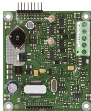
Nombre maximum de dispositifs acceptés : 250. Courant maximum absorbé : 500 mA Section des câbles utilisables : 0,4 - 2,0 mm<sup>2</sup> Température de fonctionnement -10 °C / +65 °C.
